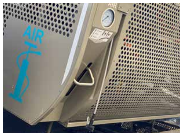
Station de gonflage à pied intégrée
