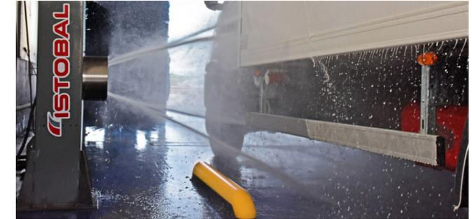
Ce modèle offre la possibilité d'automatiser le processus de haute pression afin d'éviter le lavage manuel des bas de caisse et des jantes. Il existe pour cela deux options : les buses rotatives bas de caisses, travaillant à 70 bar, 84 ou 126 L/min ou la haute pression latérale fixe, équipée de buses haute pression qui travaillent sur la partie inférieure à 70 bar 126L/min. Ces deux options peuvent être installées sur la même machine.
