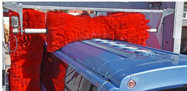
Option brosse horizontale, fonctionnant avec un contrepoids et un vérin pneumatique pour garantir un lavage en douceur de la surface supérieure du véhicule. Avec une latitude de 1,5 mètres, il permet un lavage des véhicules de différentes hauteurs. Exemple : Configuration 4,5m, la hauteur de lavage de la brosse horizontale sera de 3m à 4,5m.
