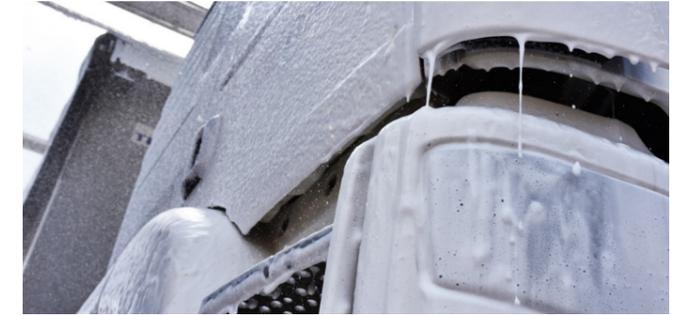
Système de pré-lavage chimique offrant la possibilité d'appliquer un produit chimique puissant pour les flottes nécessitant un lavage en profondeur. L'application est contrôlée par une pompe de 100 bar 28 L/min avec une haute résistance chimique et des tuyaux en inox. Grâce à un système venturi, elle génère un film moussant qui permet au produit chimique de s'accrocher sur le véhicule.
