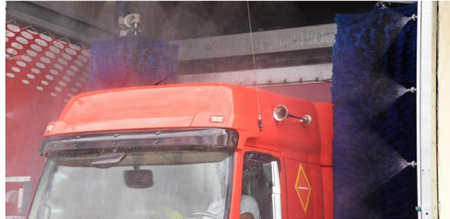
En alternative aux brosses de 1,8 mètres, ces brosses auxiliaires nettoient le côté du véhicule sur toute sa hauteur. Elles sont contrôlées par des vérins pneumatiques et par une cellule photoélectrique qui lance le lavage après avoir dépassé les rétroviseurs. Ces brosses effectuent ainsi un deuxième lavage latéral après celui des brosses verticales standard, idéal pour les flottes nécessitant un lavage plus approfondi.
