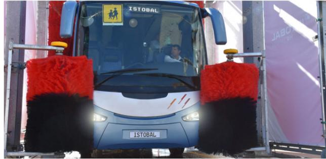
Option pour le lavage de la zone inférieure latérale des bus avec brosses de 1,8 mètres de hauteur de lavage. Grâce à leur taille compacte, elles peuvent aussi laver la face avant du véhicule sous les rétroviseurs avant, une zone d'accès difficile pour les brosses verticales. Contrôlées par un vérin pneumatique, ces brosses ont une inclinaison inférieure de 4° qui leur permet d'augmenter la pression sur les bas de caisse et sur les jantes des véhicules.
