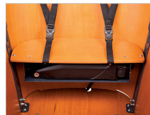
Batterie sous le banc
